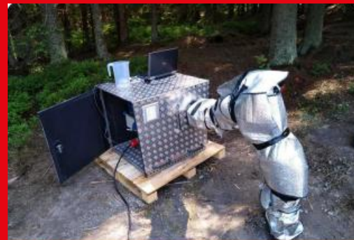
Měření TRT na pilotním vrtu
